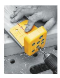
Приложив хвостовик шаблона к поверхности заготовки, позиционируйте шаблон относительно нанесённой разметки и фиксируйте его при помощи шипов.
